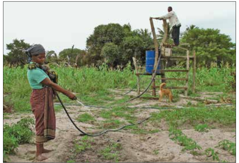
Einsatz einer Pedalpumpe in einem Gemüsefeld in Mosambik. Foto: W-3-W
